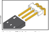
ピックアップ裏の3ピンヘッダーに コネクターを矢印が見える向きで差込ます。
